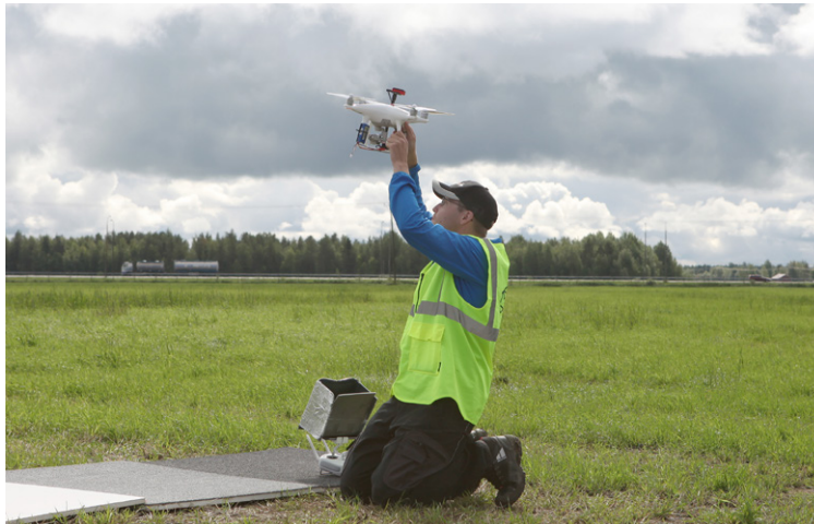
Tutkija Roope Näsi Maanmittauslaitokselta lähetti kevyen, multispektrikameralla varustetun lennokin matkaan Sohlon tilan pellolla Limingassa.
