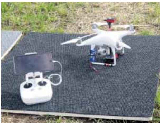
Kuvauksen suoritti kaupasta saatava peruskopteri, jossa on sisäinen kamera. Siihen on kiinnitetty myös multispektrikamera.
